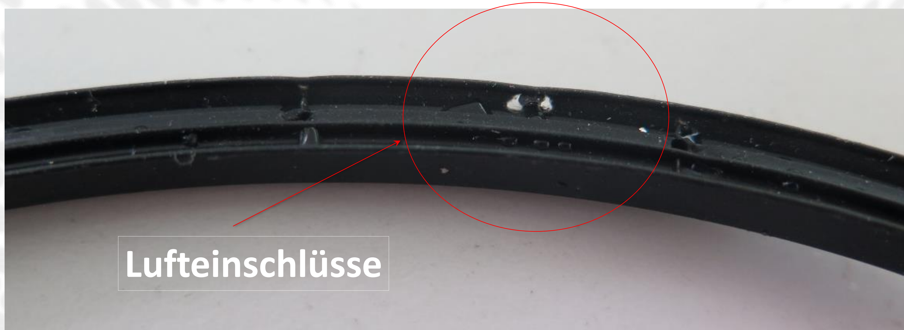
Fehlerhaftes Bauteil im ursprünglichen Verfahren
