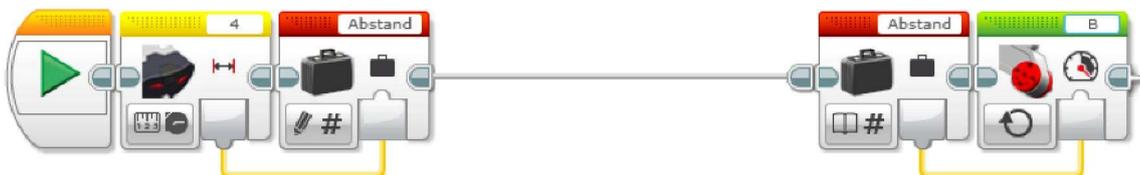
Der gemessene Abstand wird in der Variable **Abstand** gespeichert. Der Inhalt der Variable **Abstand** wird als Wert für Variable **Abstand** eine Einstellung bei einem Motor verwendet.
